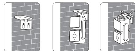
Remarque : Au cours de l'installation, assurez-vous qu'il y a un espace libre d'au moins 30 mm tout autour et 150 mm au-dessus de votre emplacement de montage. Les vis de votre support doivent être espacées d'exactly 21 mm. Utilisez deux vis de type M3x24 et une vis de type M3x24.
